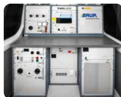
↑ 04 / transcable cable test van
